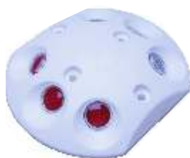
14004-MW Markierungsnagel Farbe: Weiß, PPC 120x140x25 mm, 0.12 kg mit 6 Reflexlinsen (rot/weiß) Befestigung erforderlich: 4 x Schraubnagel (13161-SN)
