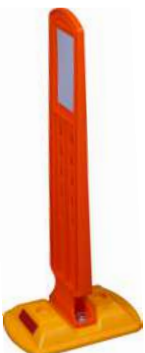
14206-GG Sichtzeichen Farbe: Gelb, PPC 260x160x600 mm, 0.84 kg mit 2 Reflektoren-rot Leitaufsatz: Farbe: Orange, TPU beidseitig Reflexfolie RA2-weiß Befestigungsset erforderlich: 1 x (13259-S2)
