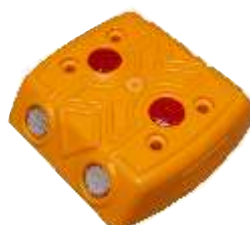
14002-MG Markierungsnagel Farbe: Gelb, PPC 120x120x28 mm, 0.17 kg mit 6 Reflexlinsen (rot/weiß) Befestigung erforderlich: 4 x Schraubnagel (13161-SN)
