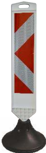
12408-LW Minibake -linksweisend- Fuß: Schwarz, PPC Ø290 mm, befüllt mit Kies Schild: Weiß, PPC Ø290 mm(150x915 mm) 5.5 kg einseitig Reflexfolie RA2 rot/weiß (Oralite 5831)
