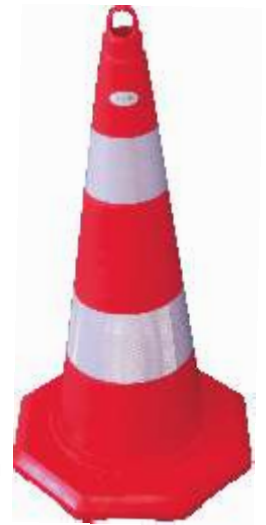
12937-ZR Leitkegel Eco Farbe: Rot, TPE (380x380) x 730 mm, 1.96 kg 2 x Reflexstreifen RA2 Achteck-Fuß
