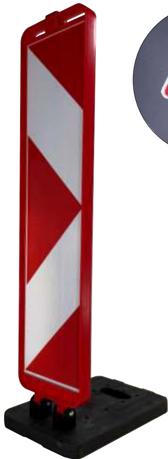
12410-PF Klappbake „Speedy-100“ Farbe: Rot, PPC (310x480) x 1200 mm, 12.0 kg mit integriertem M36 Gewinde Beidseitig Reflexfolie RA2: 250x1000 mm rutschhemmender Gummifuß Farbe: Schwarz, PVC
