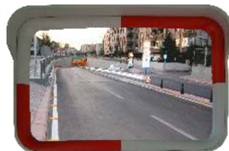
12265-RW Verkehrsspiegel Farbe: Rot-Weiß, 60 x 40 cm, Gewicht: 3.6 kg Beobachtungsabstand 0 - 15 m Material: Spiegel: Acryl, d= 2 mm Rahmen: ABS,UV-Stabil Gelenkarm: Aluminium inkl. Befestigungsmaterial für Wand- und Rohrmontage
