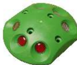
14004-GR Markierungsnagel Farbe: Grün, PPC 120x140x25 mm, 0.12 kg mit 6 Reflexlinsen (rot/weiß) Befestigung erforderlich: 4 x Schraubnagel (13161-SN)
