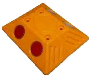
14000-MG Markierungsnagel Farbe: Gelb, PPC 125x150x32 mm, 0.20 kg mit 4 Reflexlinsen (rot/weiß) Befestigung erforderlich: 4 x Schraubnagel (13161-SN)
