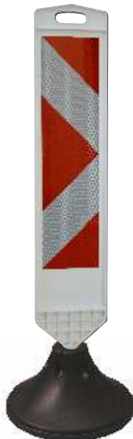
12408-RW Minibake -rechtsweisend- Fuß: Schwarz, PPC Ø290 mm, befüllt mit Kies Schild: Weiß, PPC Ø290 mm(150x915 mm) 5.5 kg einseitig Reflexfolie RA2 rot/weiß (Oralite 5831)
