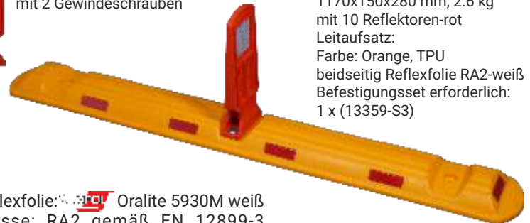
13157-ST Aufsteller Farbe: Orange, TPU, H:265 mm Reflexfolie beidseitig RA2 mit 2 Gewindeschrauben
