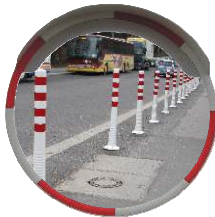
12229-RW Verkehrsspiegel Farbe: Rot-Weiß, Ø 60 cm, Gewicht: 4.0 kg Beobachtungsabstand 0 - 15 m Material: Spiegel: Acryl Rahmen: ABS, UV-Stabil Gelenkarm: Aluminium inkl. Befestigungsmaterial für Wand- und Rohrmontage
