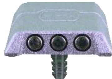
12011-MA Markierungsnagel Farbe: Silber, Aluminium 100x100x21 mm, 0.37 kg mit 6 Reflexlinsen (rot/weiß) mit Schaft zum Einsetzen Schaft: (L)50 mm, Ø 20 mm
