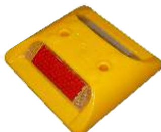
14005-MG Markierungsnagel Farbe: Gelb, ABS 105x105x20 mm, 0.11 kg mit 2 Reflektoren (rot/weiß) Befestigung erforderlich: 2 x Schraube/Dübel (13160-SC)
