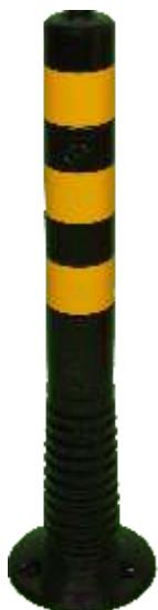
14222-SG Flexipfosten® Farbe: Schwarz, TPU H:750 mm, Ø80 mm, 1.32 kg 3 x Reflexstreifen RA1-gelb Befestigungsset erforderlich: 1 x (13359-S3)
