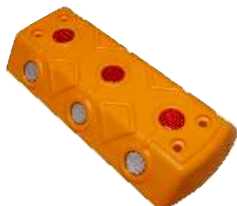
14003-MG Markierungsnagel Farbe: Gelb, PPC 100x220x32 mm, 0.24 kg mit 9 Reflexlinsen (rot/weiß) Befestigung erforderlich: 4 x Schraubnagel (13161-SN)
