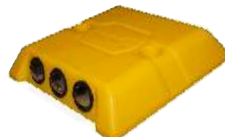
14009-MG Markierungsnagel Farbe: Gelb, ABS 105x105x20 mm, 0.11 kg mit 6 Reflexlinsen (rot/weiß) Befestigung erforderlich: 2 x Schraube/Dübel (13160-SC)
