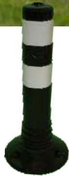
14284-SS Flexipfosten® Farbe: Schwarz, TPU H:450 mm, Ø80 mm, 0.93 kg 2 x Reflexstreifen RA1-weiß Befestigungsset erforderlich: 1 x (13359-S3)
