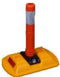
14209-MF Sichtzeichen Farbe: Gelb, PPC 260x160x280 mm, 0.7 kg mit 2 Reflektoren-rot Leitaufsatz: Farbe: Orange, TPU Reflexstreifen RA2-weiß Befestigungsset erforderlich: 1 x (13259-S2)
